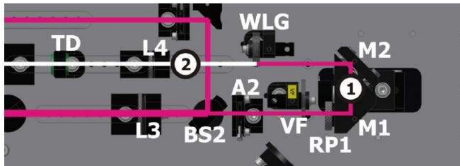
Σχήμα 2.10 Η οπτική διάταξη παραγωγής λευκού φωτός (συνεχούς). Η διερχόμενη αντλητική από τον BS1, διαχωρίζεται από τον BS2. Η διερχόμενη εστιάζεται στον κρύσταλλο παραγωγής λευκού φωτός (WLG). Έπειτα, αυτό οδηγείται προς το στάδιο πρώτης ενίσχυσης μαζί με το κομμάτι της αντλητικής που ανακλάστηκε από τον BS2.
