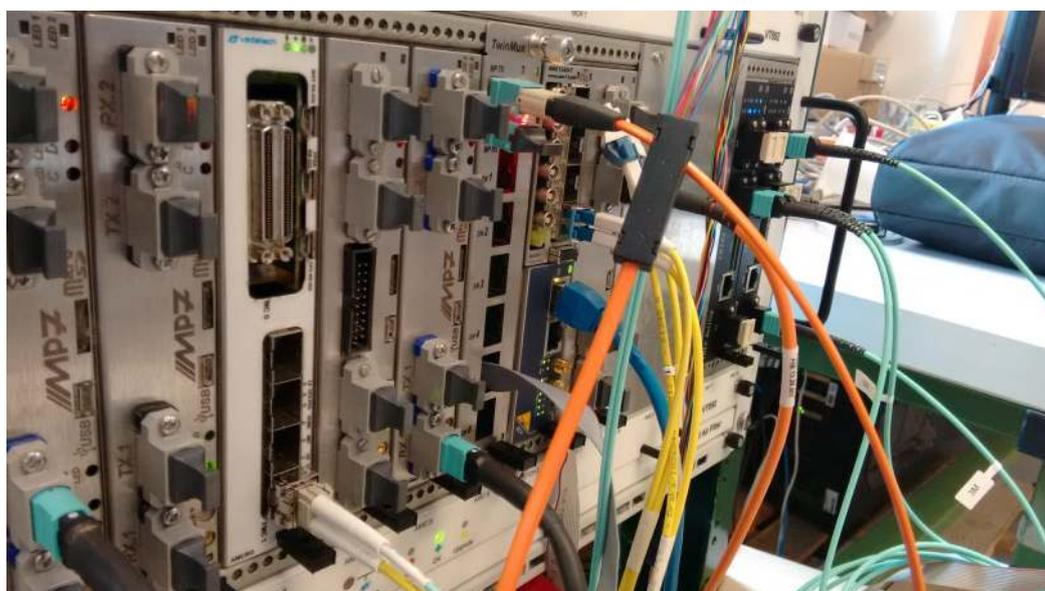
Εικόνα 14: Πειραματικό ηλεκτρονικό πλαίσιο. Από αριστερά προς τα δεξιά περιέχει τις κάρτες: Δύο MP7, μία AMC502, δύο MP7, μία TwinMux, μία AMC13 και μία MCH, μία MP7 και δύο CPPF.
