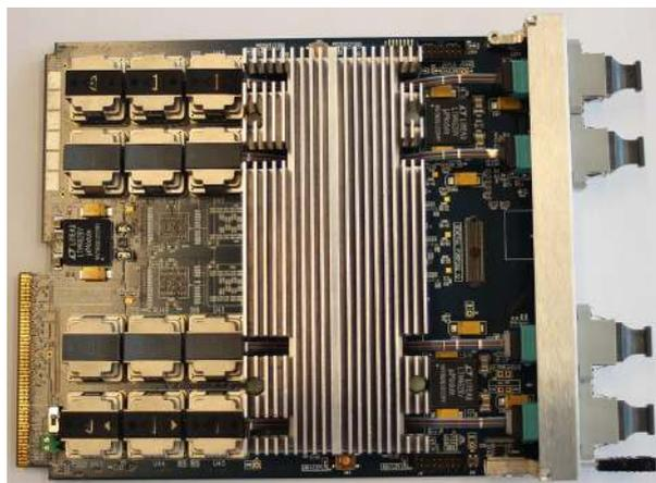
Εικόνα 3: Master Processor - Virtex-7 (MP7)
