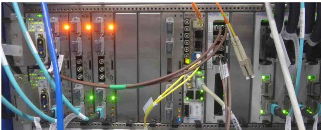
Εικόνα 13: Το πλαίσιο του συστήματος micro Global Trigger,  $\mu$ GT.
