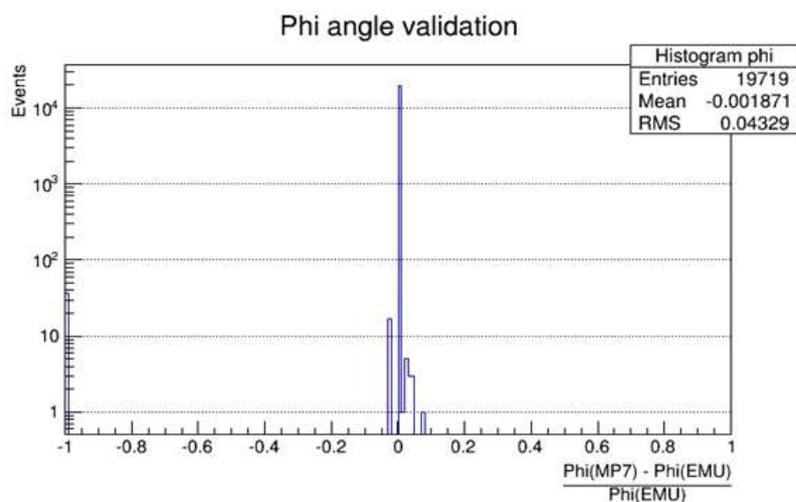
Εικόνα 16: Σύγκριση του phi της κάρτας MP7 ως προς το phi του συστήματος απομίμησης.
