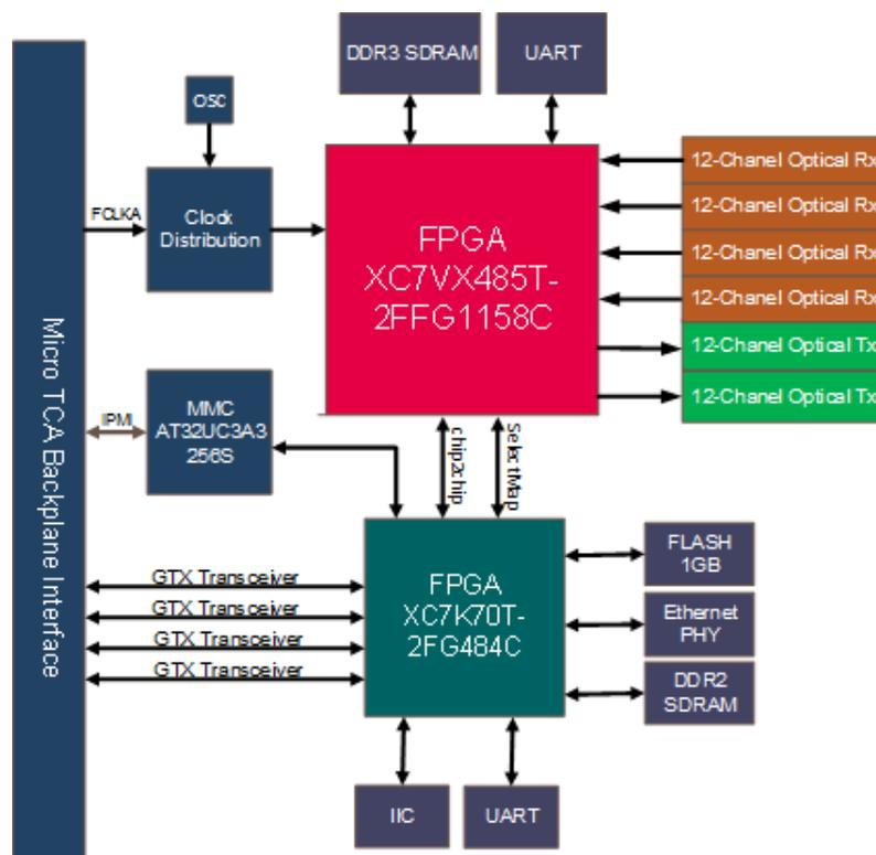
Εικόνα 11: Λογικό διάγραμμα και διασυνδέσεις του υλικού της κάρτας CPPF.
