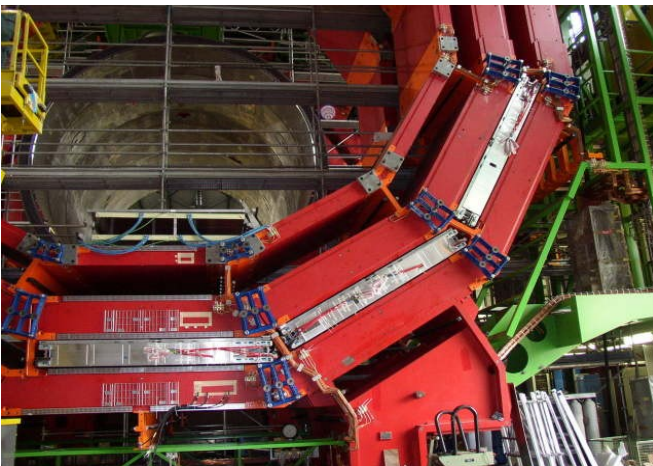
Εικόνα 26: Δύο στρώματα ανιχνευτών DT με την παρεμβολή ενός στρώματος RPC
