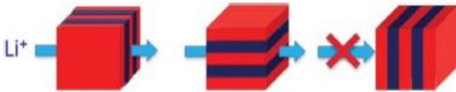
Σχήμα 2.4. Επίδραση του προσανατολισμού του κόκκου στην dc -αγωγιμότητα σε ένα σύστημα που οργανώνεται σε φυλλοειδή μορφολογία. Τα μπλε και κόκκινα στρώματα αναπαριστούν τις αγώγιμες και μη αγώγιμες περιοχές, αντίστοιχα. Από την αναφορά [17].
