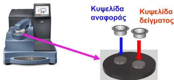
Σχήμα 5.16. Προετοιμασία του δείγματος και πειραματική διάταξη της ΔΘΣ.
