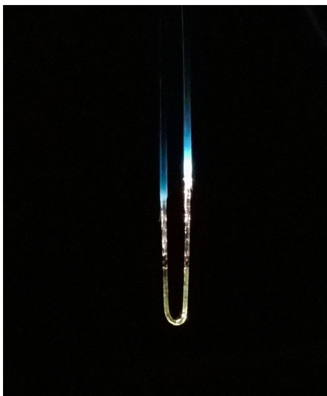
Σχήμα 5.8 Φωτογραφία μιας UTF μετά την ολοκλήρωση της διαδικασίας εναπόθεσης νανοσωματιδίων χρυσού 60 nm.
